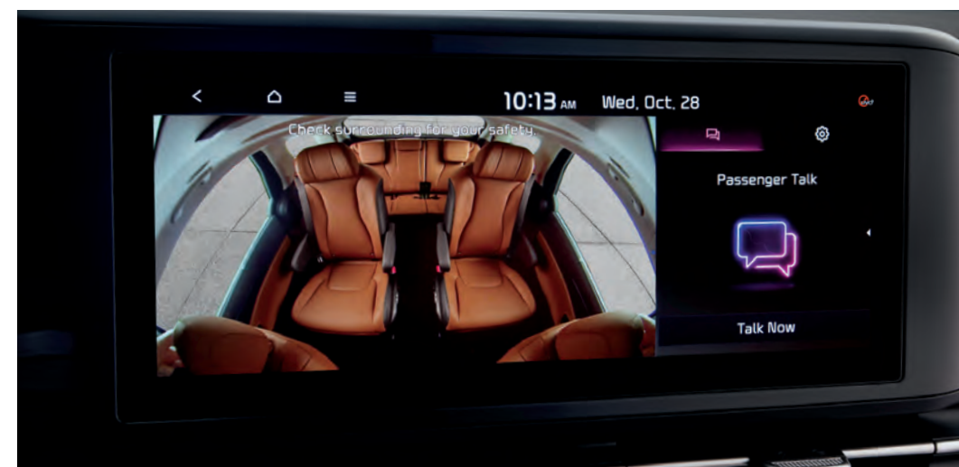
L'écran de visualisation des passagers arrière 1 permet au conducteur de jeter un coup d'œil sur les passagers arrière... de jour comme de nuit.
