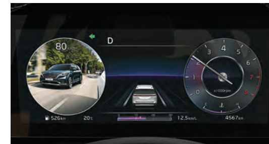
L'écran d'affichage des angles morts 1 s'allume automatiquement au tableau de bord lorsque vous mettez le clignotant. L'angle mort correspondant au côté du clignotant s'affiche alors.
