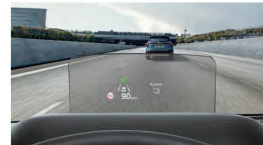
**L'affichage tête haute (HUD)<sup>1</sup>** projette subtilement les informations de conduite importantes sur un écran secondaire placé au-dessus du volant.
